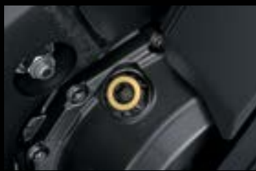
Korek wlewu oleju 990D0-17K36-000 Aluminiowy, ze złotym wykończeniem i logo „S”.
