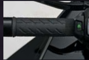
Podgrzewane manetki 57100-10810-000 3 poziomy regulacji temperatury. Rozkład temperatur uwzględnia anatomiczne ułożenie dłoni na manetkach.
