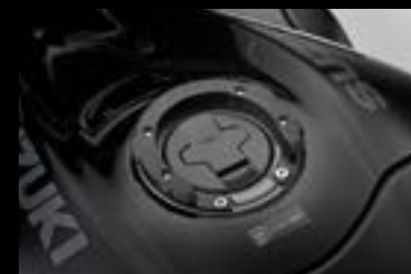
Pierścien mocowania sakwy 99148-00A00-000 Niezbędny do mocowania na zbiorniku paliwa sakwy dużej (990D0-04600-000) lub małej (990D0-04300-000).
