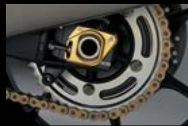
Napinacz łańcucha 99117-10L00-000 Aluminiowy, ze złotym wykończeniem i logo „Hayabusa” w alfabecie Kanji. Zestaw na prawą i lewą stronę.
