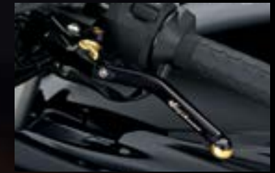
Dźwignia sprzęgła 99151-10L00-000 Aluminiowa, z logo „Hayabusa”. Możliwość wyboru jednego z 4 położenia dźwigni.
